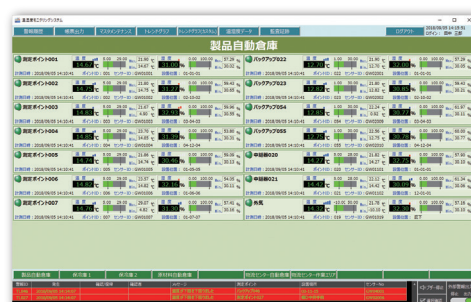
温湿度モニタリング画面例。最大50地点の温湿度を時系列データで監視できる。
