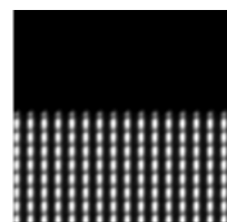
図 7 アクティブエリア端誤検出時の画像(疑似欠陥)
