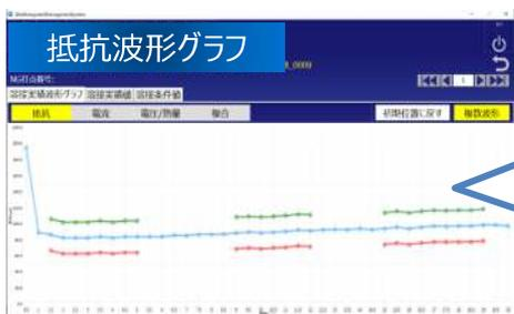
抵抗波形に閾値を設定することにより良否判定が可能です。また、左図のように3段階で閾値の設定ができます。ドレス後の空通電により、ドレス不良を自動検知し品質の安定化に貢献します！！
