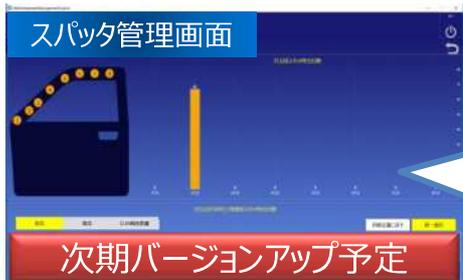
スパッタ検知機能により、打点毎のスパッタ発生回数を見える化。また、スパッタが発生したサイクルを可視化することで、スパッタレス化等の溶接条件変更の参考データとして活用できます。
