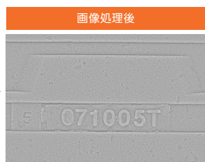
柄を除去して凹凸を強調して文字 認識のしやすい画像取得が可能。
