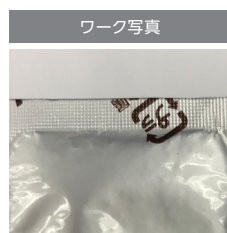
画像処理後 中心の凹みの影の影響を無くした画像取得が可能。 また、凹凸を強調させ文字をくっきりと見えるように することが可能。
