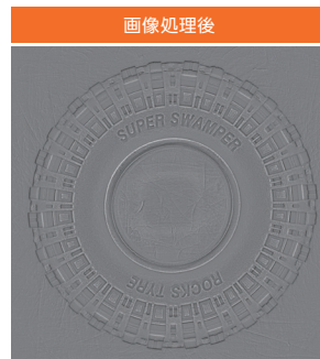
画像処理後 中心の凹みの影の影響を無くした画像取得が可能。 また、凹凸を強調させ文字をくっきりと見えるように することが可能。
