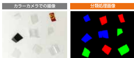
青色:PS 緑色:PET 赤色:PP 3種類の材質の違いを分類化
