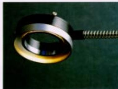
リングファイバーから射出した光が、反射リングにより外側に反射し、さらに反射フード内側で反射・拡散し照射されます。レーザーマーカー文字認識等に最適です。
