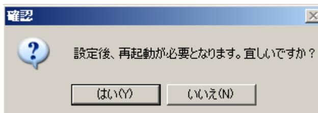
※FV2340 では、装置の再起動が行われ、WriteFilter が Disable となり、C ドライブへの書き込みが有効な状態で起動します。
