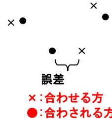
このときの誤差の標準偏差を $\sigma$ として、少数の無視したいはずれ値が $k\sigma$ 以上にある場合、しきい値 $t$ を $t=k$ の付近で設定すればはずれ値を除外したロバストマッチングを行うことができます。(下図参照)
