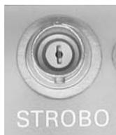
ストロボ装置に対して、ストロボ発光パルスを出力します。ストロボ装置のトリガ端子に接続してください。
