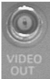
TV モニタに接続します。(TV モニタ側は必ず 75Ω 終端してください。)
